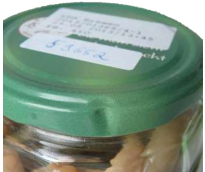
Deckelrand mit Beschädigung
