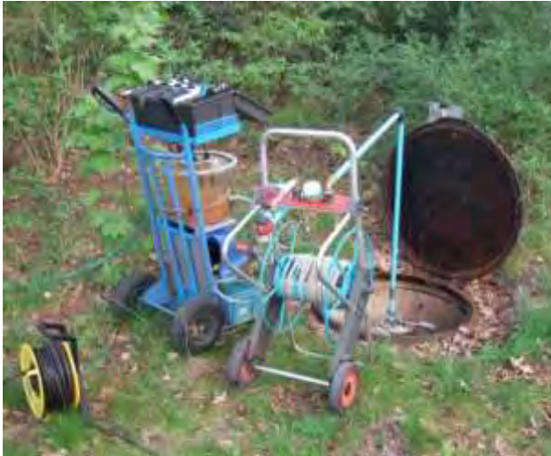
Probenahme aus Grundwasserleitung
