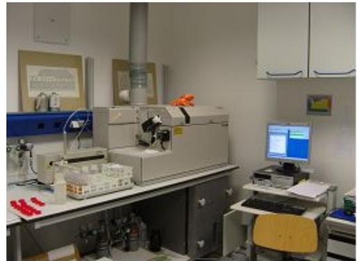
Abbildung 34: Messplatz zur Bestimmung von Elementen/Schwermetallen
