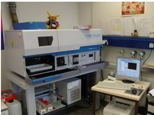
**Abbildung 32:** Messplatz zur Bestimmung von Elementen/ Schwermetallen in Wasser
