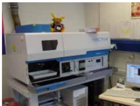
Messplatz zur Bestimmung von Elementen/Schwermetallen in Wasser
