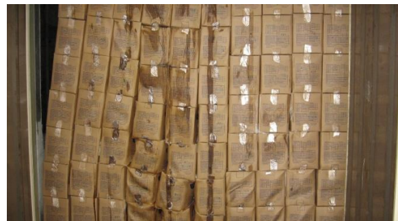
Verfärbung und Verformung von angetauten Kartons mit Fischfilets im Container durch Unterbrechung der Kühlkette
