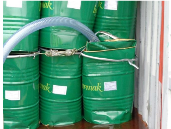
zerdrückte Honigfässer mit Kontamination des Containerbodens
