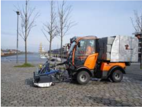
Heißwasserverfahren, hier „Wave“ in der Überseestadt
